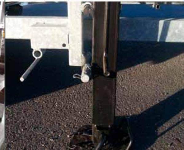
Béquille manuelle pour relevage et la mise à niveau du châssis
