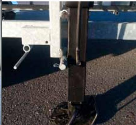
Béquille manuelle pour relevage et mise à niveau du châssis
