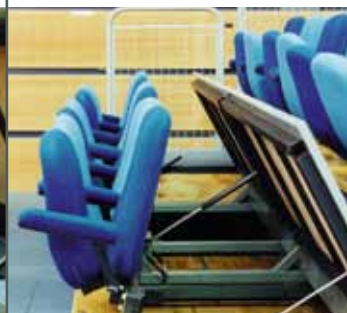
Mise en place des fauteuils, manœuvre assistée par ressorts de compensation
