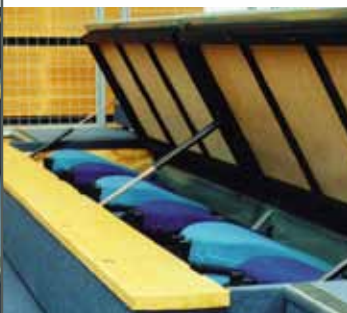
Ouverture du coffre, manœuvre assistée par vérins à gaz
